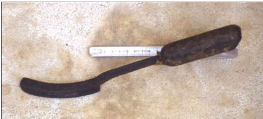
Planchín elaborado en hierro fundido y con mango de madera; se utiliza exclusivamente para el planchado del ala.
