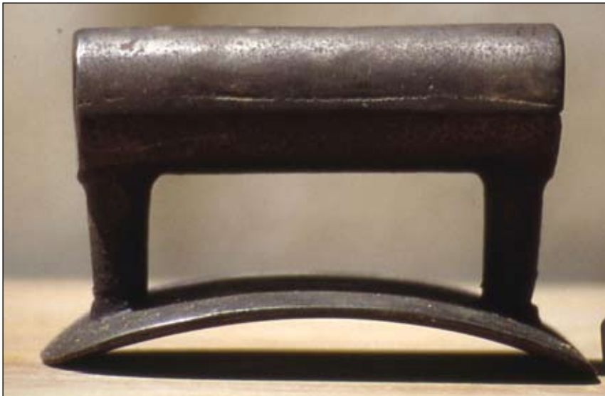
Lisuar o alisador. Modelo especial de plancha que se utiliza después de las planchas anteriores aprovechando el calor que dejan sobre el fieltro, para conseguir mediante presión una mayor adhesión y unión de dicho fieltro.
